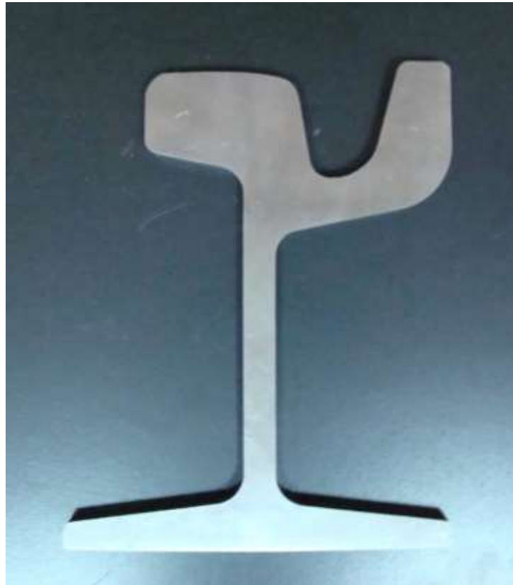
Рисунок 3.20 – Темплет поперечного сечения трамвайного рельса после прокатки в чистовом калибре UF из НЛЗ с максимальной осевой пористостью
