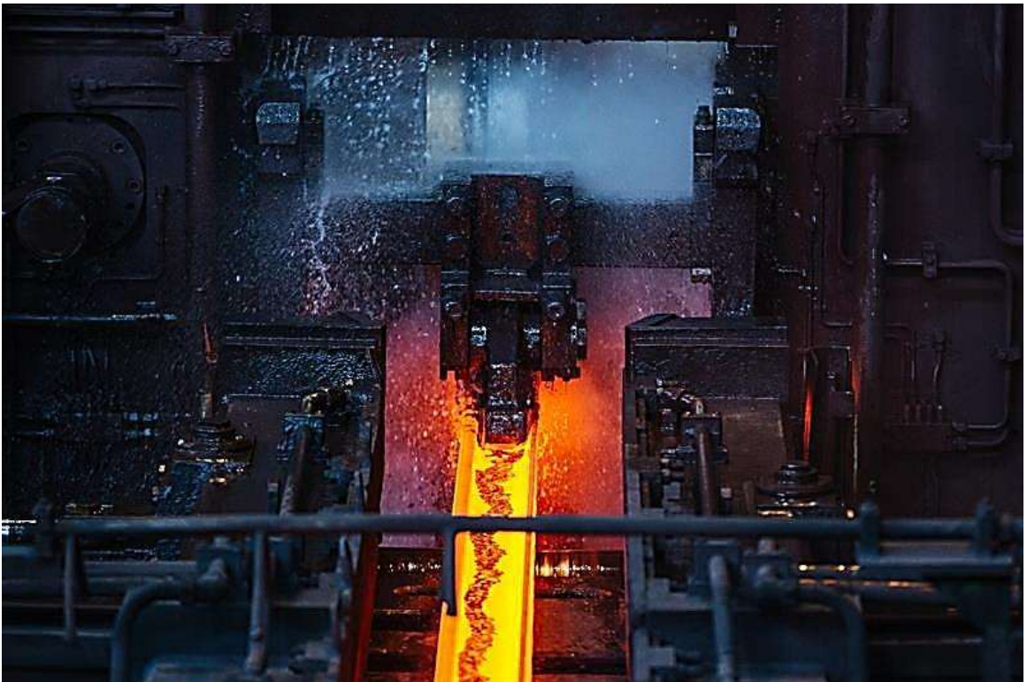
Рисунок 3.9 – Система охлаждения валков при прокатке трамвайных рельсов в непрерывной группе клеток тандем на выходе из клетки UF
