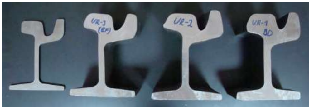
Рисунок 3.14 – Темплеты очага деформации калибров клеток группы тандем: а – темплеты из раската, прокатанного по эксперименту №3; б – темплеты из раската, прокатанного по эксперименту №13; в – темплеты из раската, прокатанного по эксперименту №14
