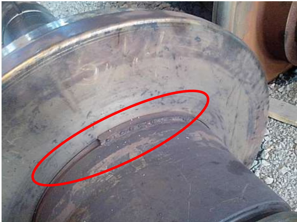
Рисунок 4.13 – Горизонтальный прокатный валок универсальной клетки группы тандем по проектной технологии с установленными в проточках ограничителями (секторами) для предотвращения смещения бандажа в сторону подошвы из-за неуравновешенности горизонтальных сил прокатки: а – вид со стороны профиля валка; б – вваренный сектор, предотвращающий смещение бандажа
