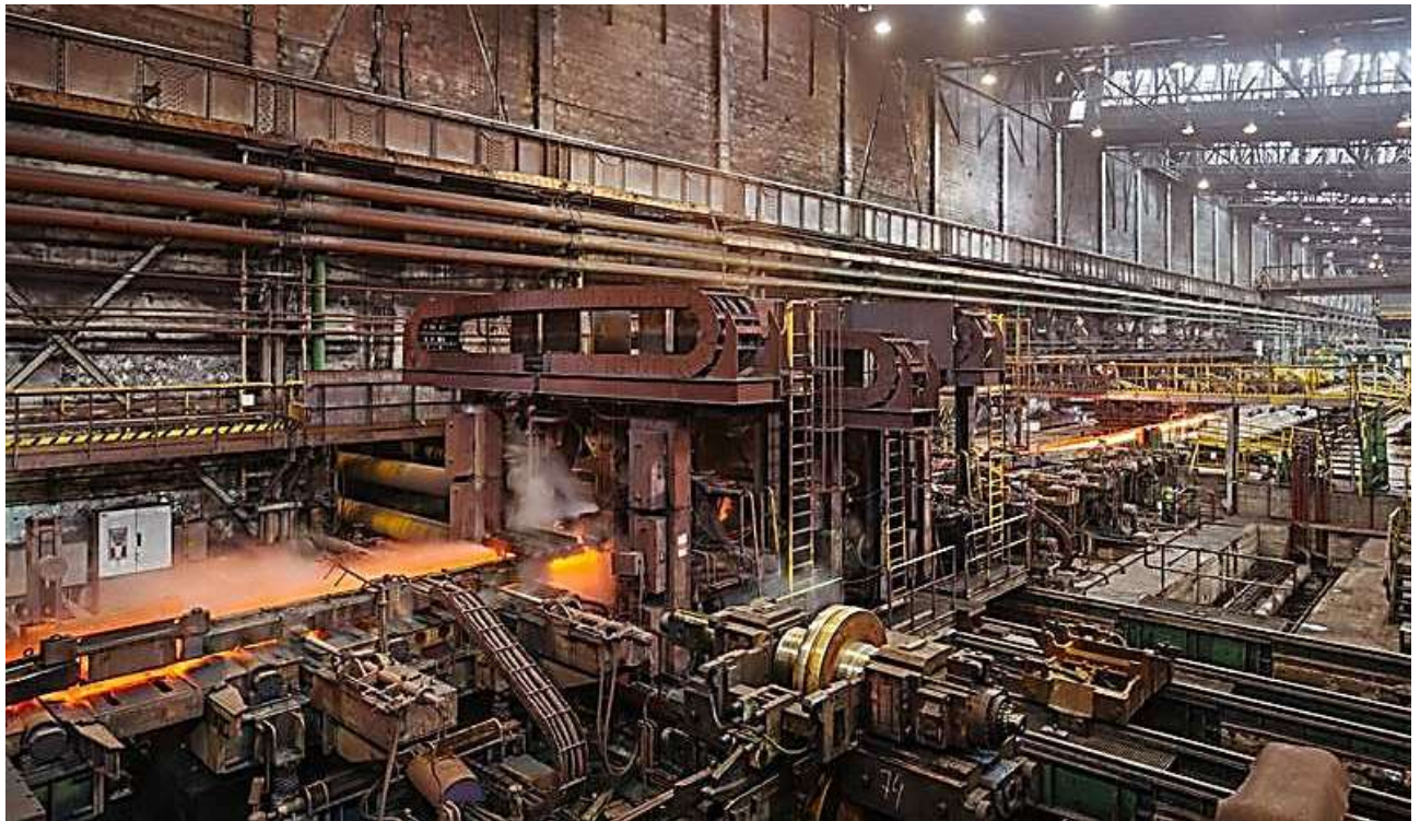
Рисунок 3.7 – Непрерывная прокатка трамвайных рельсов в клетях группы тандем в третьем проходе
