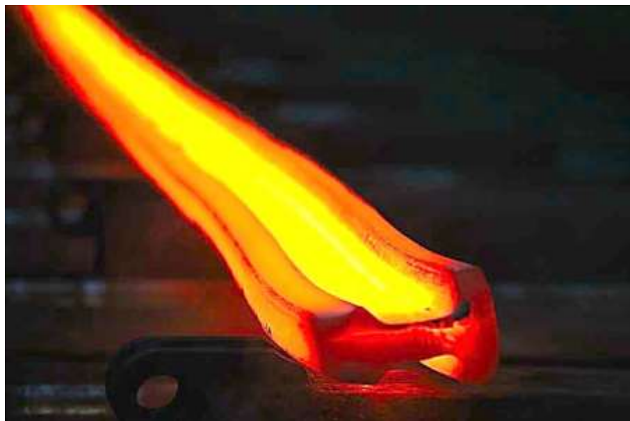
Рисунок 3.6 – Контроль температуры раската трамвайного рельса перед первым проходом в чистой реверсивной группе клетей
